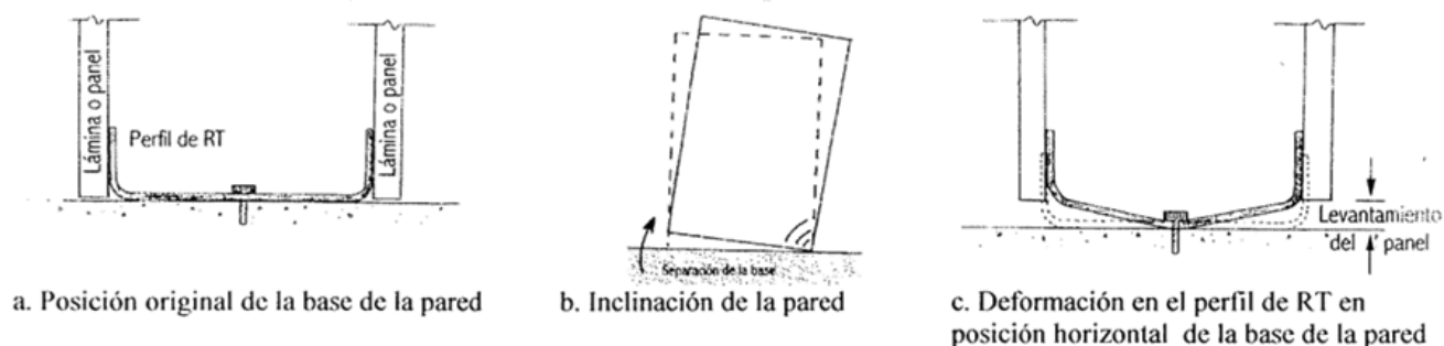
Figura 7.25. Separación permanente de la pared respecto al contrapiso o entrepiso
