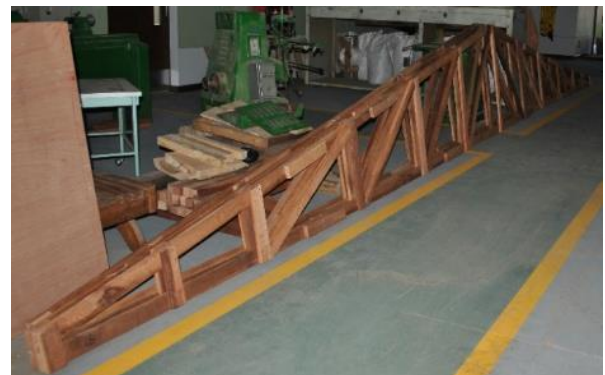
Figura 6.35. Cercha construidas con reglas de madera
