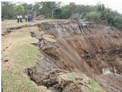
Figura 9.11. Deslizamiento de talud y grietas en la corona del talud
